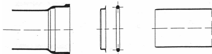
раструб чугунной трубы
