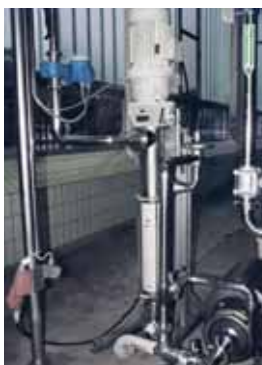
Насос seerex BCSO 17-12, продукт: сливки, пудинг и десертные продукты, температура: 25°C, давление: 6 бар, CIP-чистка: 3%-ый натриевый щелок и 2%-ая азотная кислота при 70-95°C около 1ч, производительность: 5-10 м 3 /ч
