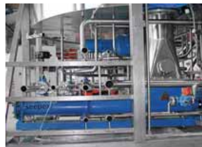
Насос seerex BT 17-12, продукт: сырая дробина от фильтрационного чана на переработку в корм для животных, давление: 4-10 бар, вязкость: до 15000 сП, температура: 70-80°С производительность: 8 м 3 /ч
