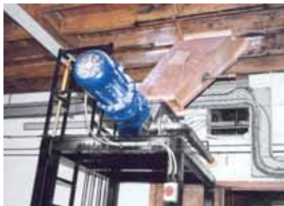
Насос seerex BT 17-12, продукт: смесь зерна и воды от мельницы к заторному котлу, давление: 2 бар, температура: 65°C производительность: 5-12 м³/ч
