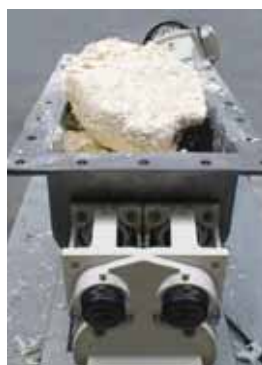
Насос seerex BTCI 10-12, для размельчения и перекачивания мягких сыров, вязкость: не текучие, температура: -от 1,3 до 2°C, давление: 7 бар, производительность: 2,3 м 3 /ч
