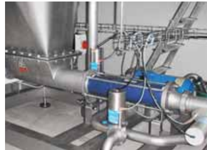
Насос seepex BTCS 10-12, продукт: томатная паста из емкостей, температура: 20°C давление: 3 бар, вязкость: не текучая, производительность: 0,5-1,3 м³/ч
