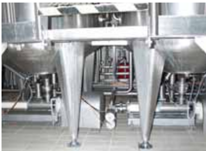
Насосы seepex BCSO 5-6L, продукт: сырая паста с кусочками овощей, вязкость: 8000 сП, температура: 60°C давление: 4 бар, CIP-чистка: при 80°C с 2%-ым раствором NaOH, при 65°C с 1,5%-ым раствором HNO3, производительность: 0,1-1,5 м³/ч
