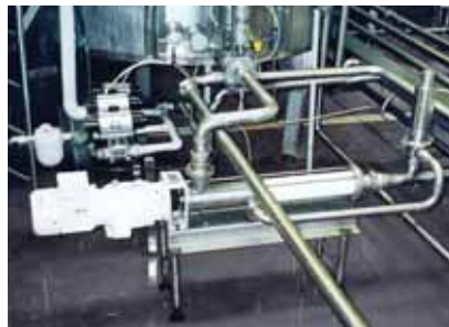
Насос seerex BCSB 10-12, продукт: кизельгур к филтрации, давление: 3 бар, температура: 20-40°C производительность: 3 м³/ч
