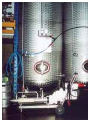
Насос seerex BCSB 10-6L, продукт: виноградная выжимка давление: 2 бар, производительность: 5-7 м 3 /ч
