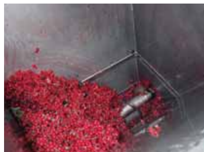
Вид со стороны загрузочной воронки насоса seerex ВТМ 10-12 во время размельчения и транспортировки смородины
