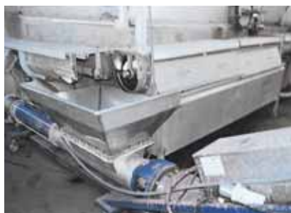
Насос seerex BT 130-6L, продукт: виноградная мезга, давление: 4 бар, производительность: 75 м 3 /ч
